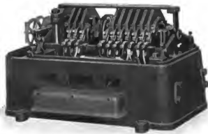
Fig. 191. Umkehranlasser (geöffnet) für Druckknopfsteuerungen der A. E.-G.
